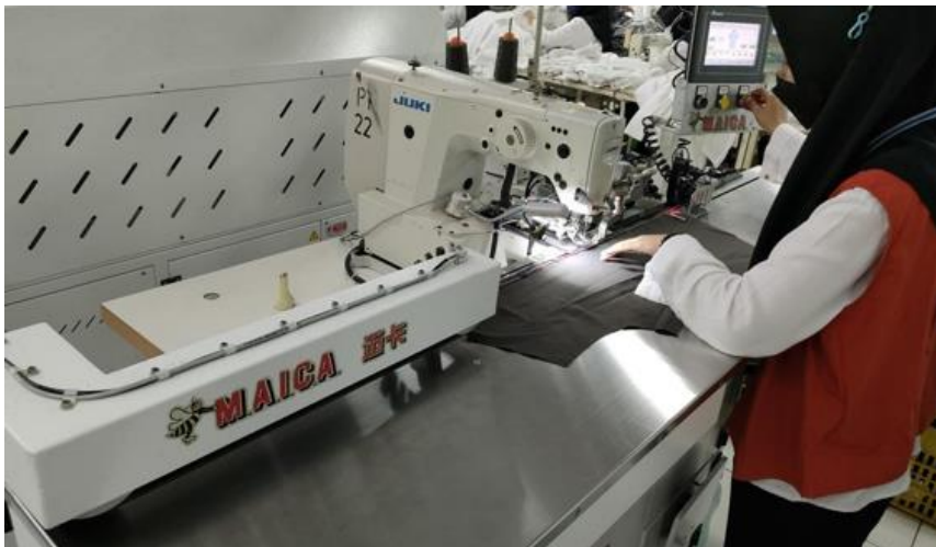
Proses Pemasangan Kancing
